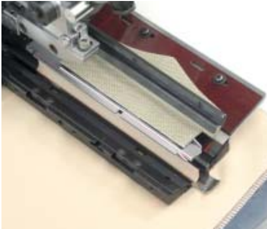
Anwendungsbeispiel Hinterhosentasche: Einfache Positionierung der Patte durch offenen Faltstempel Example of application: Hind trouser pocket; easy positioning of flaps due to open folder
