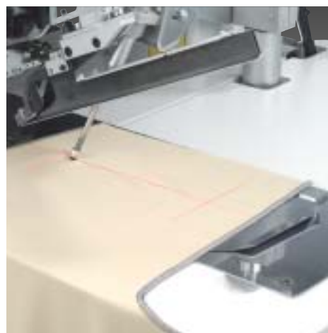
Taschenbeutelklemme und Niederhalter für Hosentaschen-Anwendungen Pocket bag clamp and dart stretcher for trouser operations
