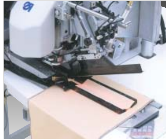
Anwendungsbeispiel: Hinterhosentasche mit Doppelpaspel Example of application: Hind trouser double welt pocket
