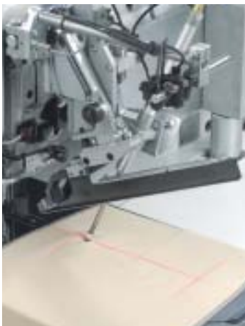
Drei Laser-Markierungsleuchten für schnelles und exaktes Positionieren des Nähguts Three standard laser lights for fast and precise loading of the fabric
