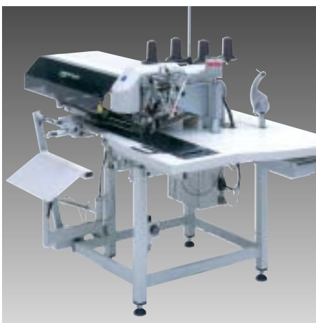
Ergonomisches, höhenverstellbares Gestell Ergonomic, high-adjustable stand
