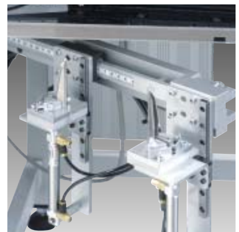
Einfach justierbares Eckeneinschneid- system Easy adjustable corner knife system
