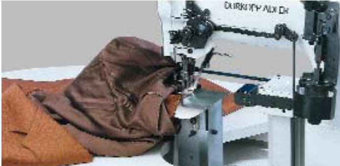
Arbeitsgänge der 697-15155: Wattelinestreifen knapp neben der Ärmelnaht einnähen, Ärmelfutter in Armlöcher nähen Operations of class 697-15155: Inserting wadding strips close to the sleeve setting seam; sewing sleeve lining into armhole
