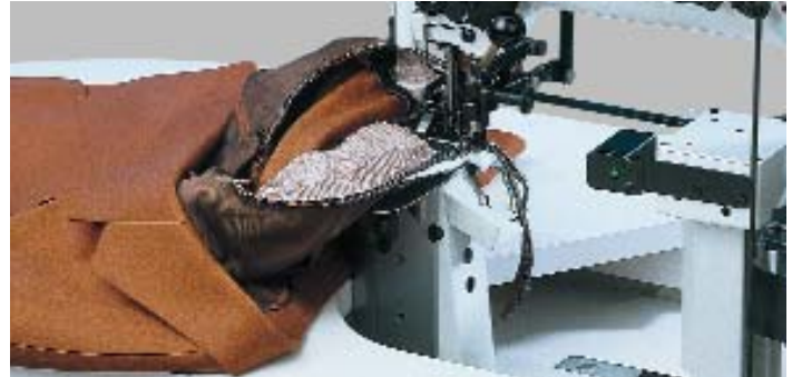
Arbeitsgänge der 697-24155: Schulterpolster in Armlöchern festnähen und beschneiden; Leibfutter in Armlöcher nähen und beschneiden Operations of class 697-24155: Attaching shoulder pads to armholes and trimming edges; attaching body lining to armholes and trimming edges
